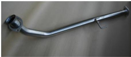
**ECHAPPEMENT INOX : DECATALYSEUR\*\* (102HP
