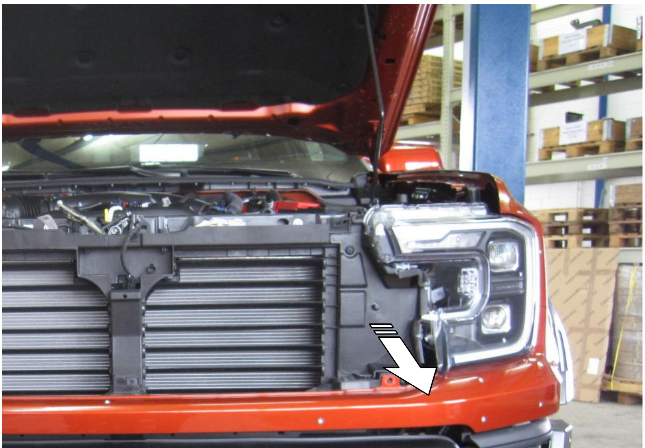
4 Linke Abdeckung entfernen! / Remove the cover left!
