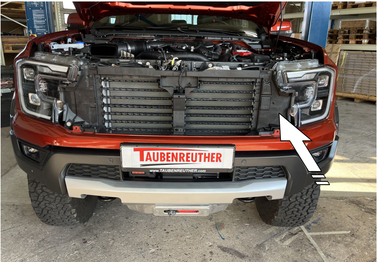
44 Linke Abdeckung wieder montieren! / Mount the cover left again!
