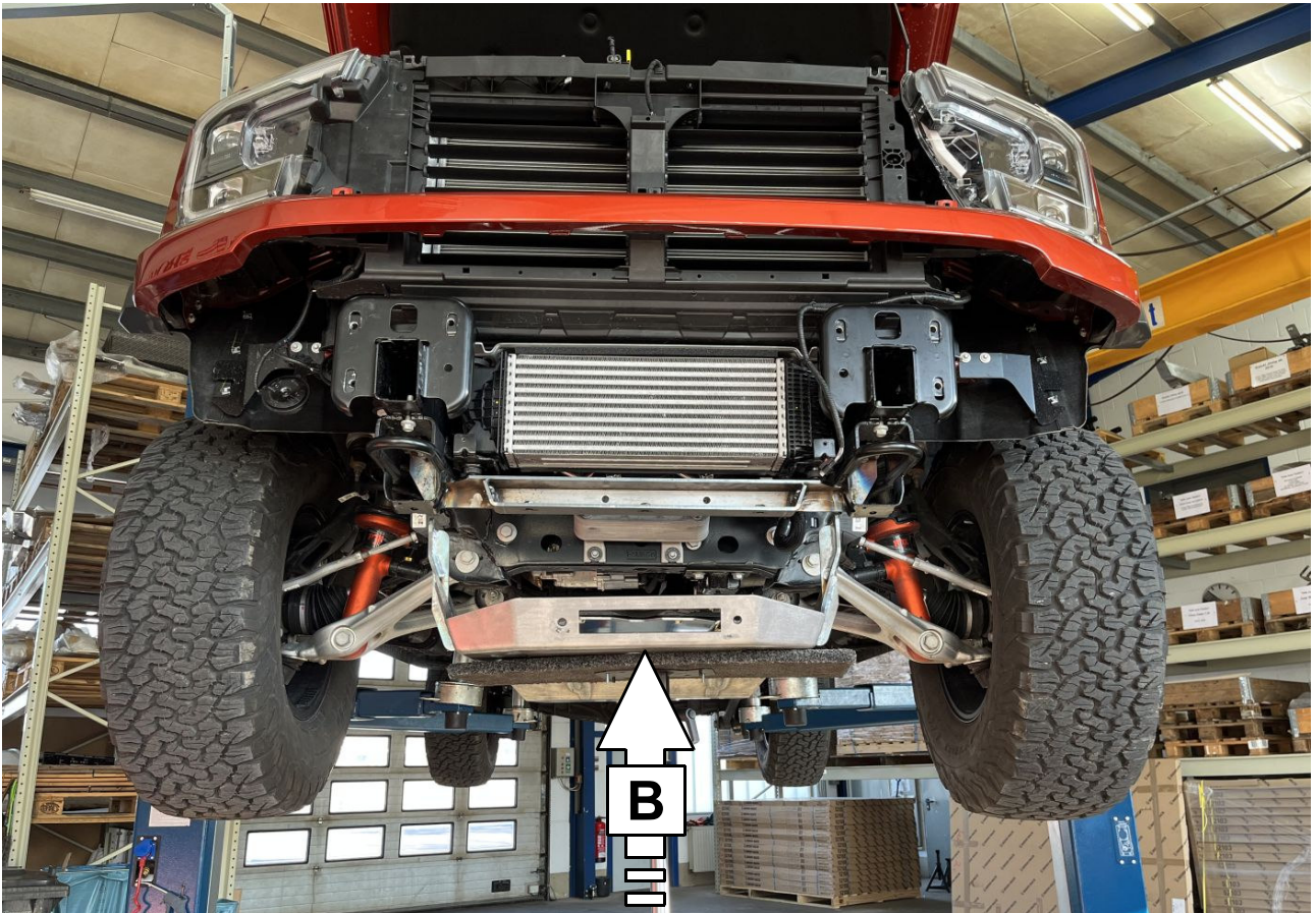
13 Windenaufnahme platzieren! / Place the winch plate!
