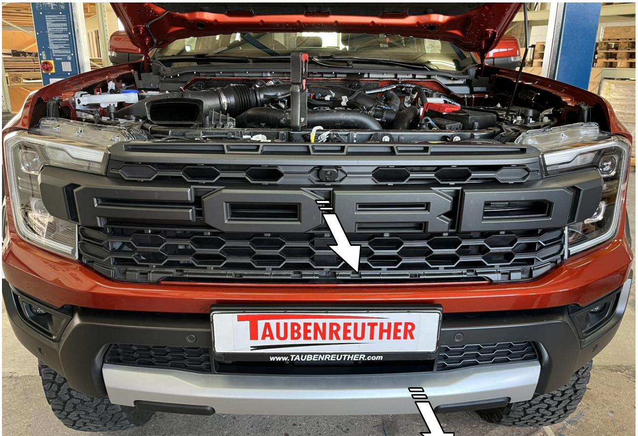
3 Kühlergrill und untere Abdeckung entfernen! Remove the Radiator grille and the under cover!
