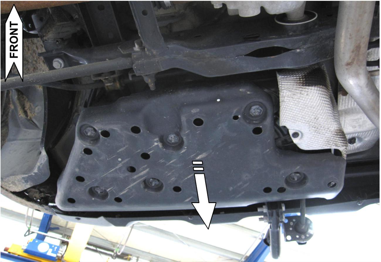
**1** Abdeckung entfernen! / *Remove the cover!*
