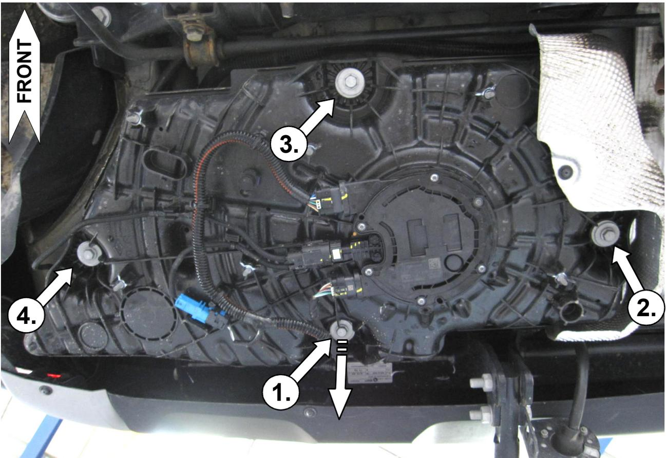
**2** Schritt für Schritt die Schrauben herausdrehen und die Halter befestigen!
