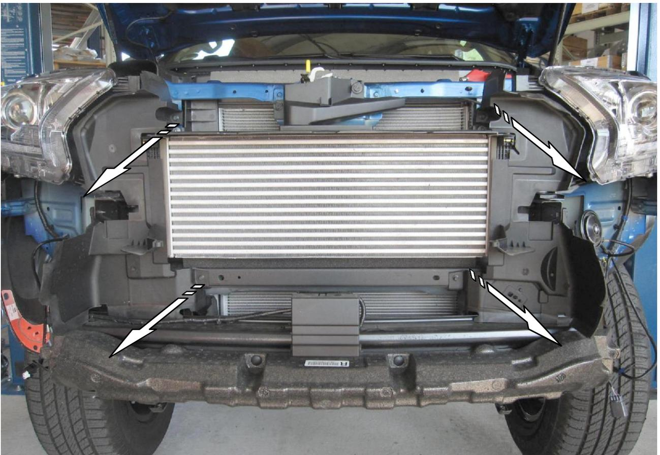
**2** **Schrauben entfernen! / Remove screws!**
