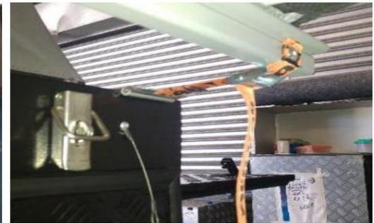
**Étape 5 :** Deux bandes de mousses adhésives noires sont fournies avec le store. Décollez le plastique blanc et collez ces bandes de mousse au bas des bras de l'auvent pour empêcher les portes latérales et arrière d'un auvent, d'un camping-car ou de tout autre véhicule d'encrasser les bras de l'auvent.
