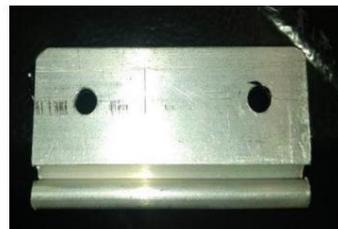
Figure 5 : Pince en C extrusion avec trous percé
